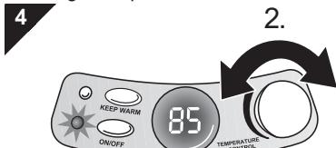
3. Sélectionnez maintenant la température désirée en tournant le bouton de réglage de température (ill. 4/2).
