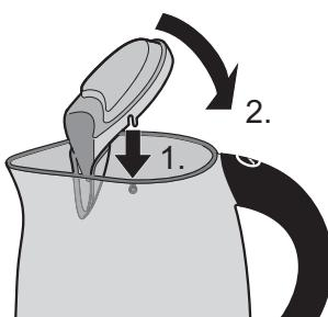
1. Setzen Sie den Deckel wie abgebildet auf den Wasserkessel auf (Abb. 2/1.). Schieben Sie den Deckel mit den beiden Aussparungen auf die zwei Stifte am Rand des Wasserkessels (Abb. 2/1.).
