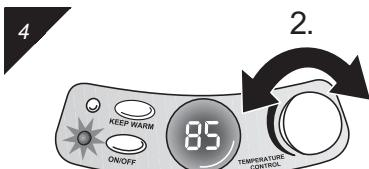
3. Stellen Sie nun durch Drehen des Temperatur-Drehreglers (Abb. 4/2.) die gewünschte Wassertemperatur ein.
