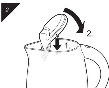
1. Setzen Sie den Deckel wie abgebildet auf den Wasserkocher auf (Abb. 2/1.). Schieben Sie den Deckel mit den beiden Aussparungen auf die zwei Stifte am Rand des Wasserkochers (Abb. 2/1.).
