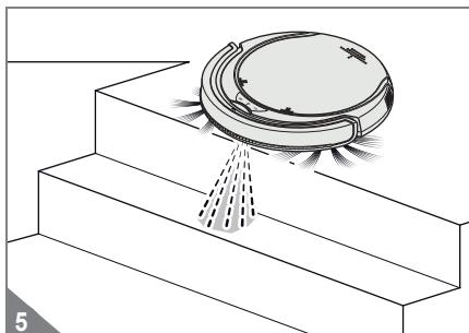
Uw zuigrobot herkent met behulp van 3 valsensoren zelfstandig vóór hem liggende afgronden (afb. 5). De robot wijzigt daarna de rijrichting en gaat in tegengestelde richting door met reinigen.
