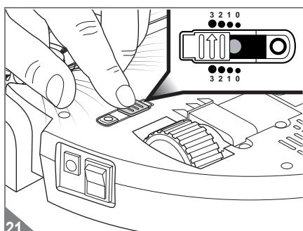
1. Stellen Sie sicher, dass das Gerät ausgeschaltet ist (Stellung „0“).
