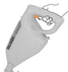
Buhar oluşturmak için, küçük püskürtmeler yapacak şekilde tetiği basın. Zemini gereğinden fazla ıslatmamak için, tetiğe sürekli basmayın.
