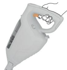
Buhar oluşturmak için, küçük püskürtmeler yapacak şekilde tetiğe basın. Zemini gereğinden fazla islatmamak için, tetiği sürekli basılı tutmayın.
