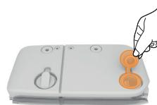
Ta tag i dubbelbehållaren och dra i fliken på vattenbehållarens lock för att öppna behållaren.
