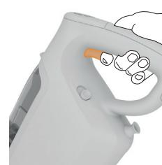
Buhar oluşturmak için, küçük püsürtmeler yapacak şekilde tetiğe basın. Zemini gereğinden fazla ıslatmamak için, tetiği sürekli basılı tutmayın.
