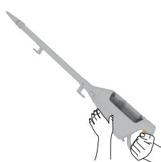
Tuottaakesi höyryä, purista kytkimestä lyhyen aikaa kerralla. Älä pidä kytkintä yhtäjaksoisesti pohjassa. Näin vältät liian kostumisen.
