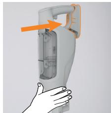
Tryck hårt på handtaget och väggfästet för att fästa fästet i rätt ställning.
