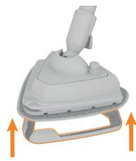
Med mikrofiberdynan på plats, skjut golvverktyget till mattrengöraren, tryck sedan golvverktygets bakdel ner för att fästa den till clipset. Mattrengöraren ska användas endast för att fräscha upp mattor.
