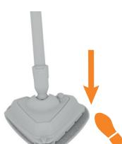
Efter att du fräschat upp mattorna, släck apparaten och lossa den ur eluttaget. Låt apparaten svalna. Håll i hörnet av mikrofiberdynan med din fot och lyft loss apparaten.
