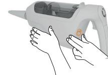
Koppla ångrengöraren till eluttaget och ställ strömställaren till läget On. Gröna lampan tänds när apparaten är redo att användas. Apparaten går automatiskt till läget max ånga (inget tvättmedel).
