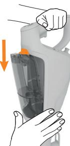
Tryck på dubbelbehållarens frigöringsknapp, ta tag i behållaren och lossa den.
